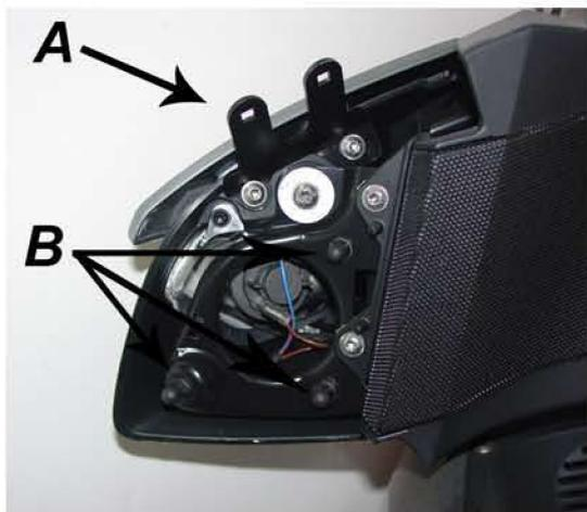
Demontieren Sie den Spiegel und das Spiegelgehäuse. Ziehen Sie diesen nach hinten ab.
