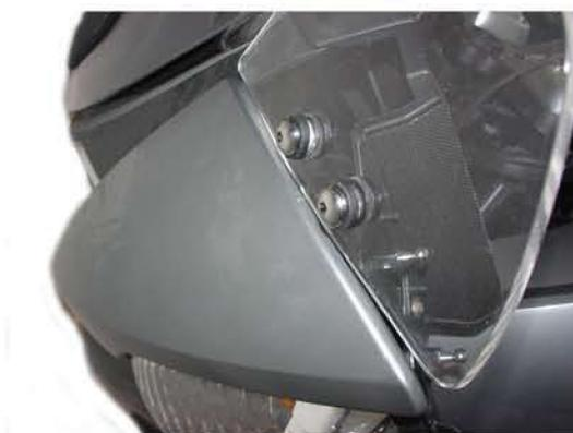
Setzen Sie nun die Gummitüllen in den Handprotektor ein und montieren Sie den Handschutz mit den Schlossschrauben und den Spezialmuttern.
