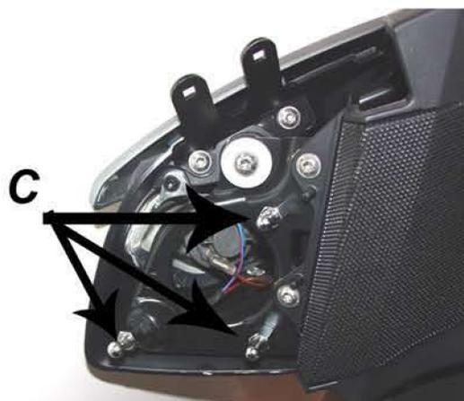
Montieren Sie nun die Halter ( Bild C) mit den mitgelieferten M6 Muttern.
