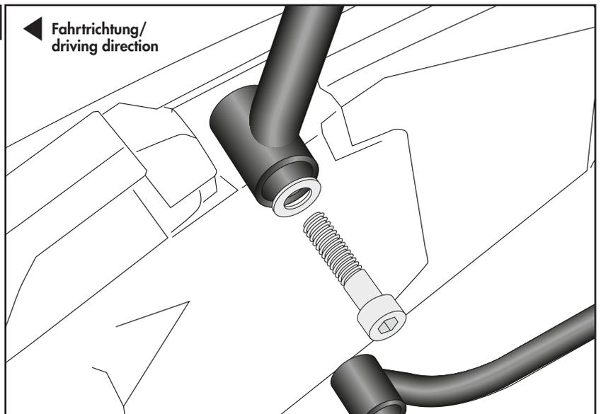
**Montage Heckschutzbügel vorne rechts:**
