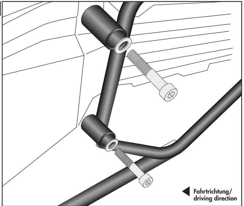
**Montage Heckschutzbügel vorne links:**
