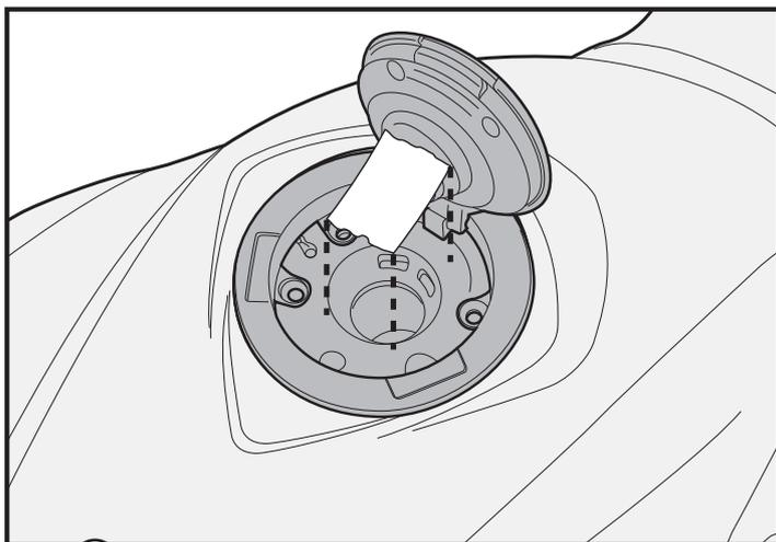
. PRIMA DI PROCEDERE APPLICARE DELLO SCOTCH SUL FORO DEL SERBATOIO PER EVITARE DI PERDERE DELLE VITI.
