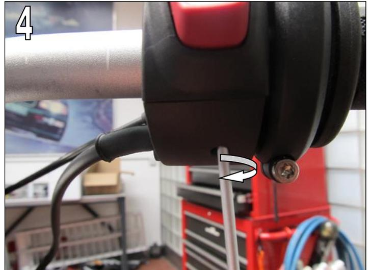
An freigelegter Elektroeinheit Befestigungsschraube demontieren, Steckverbindungen trennen und Elektroeinheit abnehmen. (Abb. 5)
