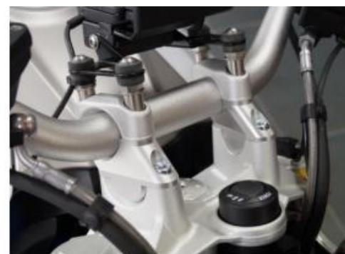
**Hinweis:** Bitte achten Sie nach erfolgter Montage darauf, dass auch bei voll eingeschlagenem Lenker der Brems- und Kupplungsschlauch, Züge und Kabel weder spannen noch scheuern! **Note:** Please ensure that the brake and clutch hose and cables are not tensioned or chafed even when the handlebar is at steering stop.
