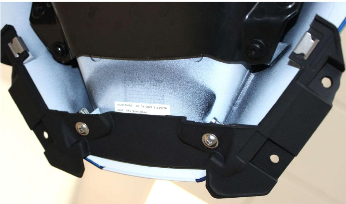
**Schritt 3: Legen Sie die beiden Endkappen links und rechts auf das Unterteil**
