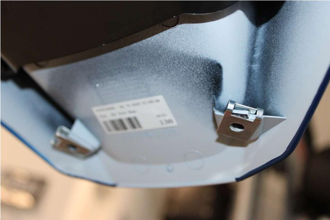
**Schritt 2:** Montieren Sie das Unterteil der Schnabelverbreiterung mittels der beiden Schrauben und Klammern
