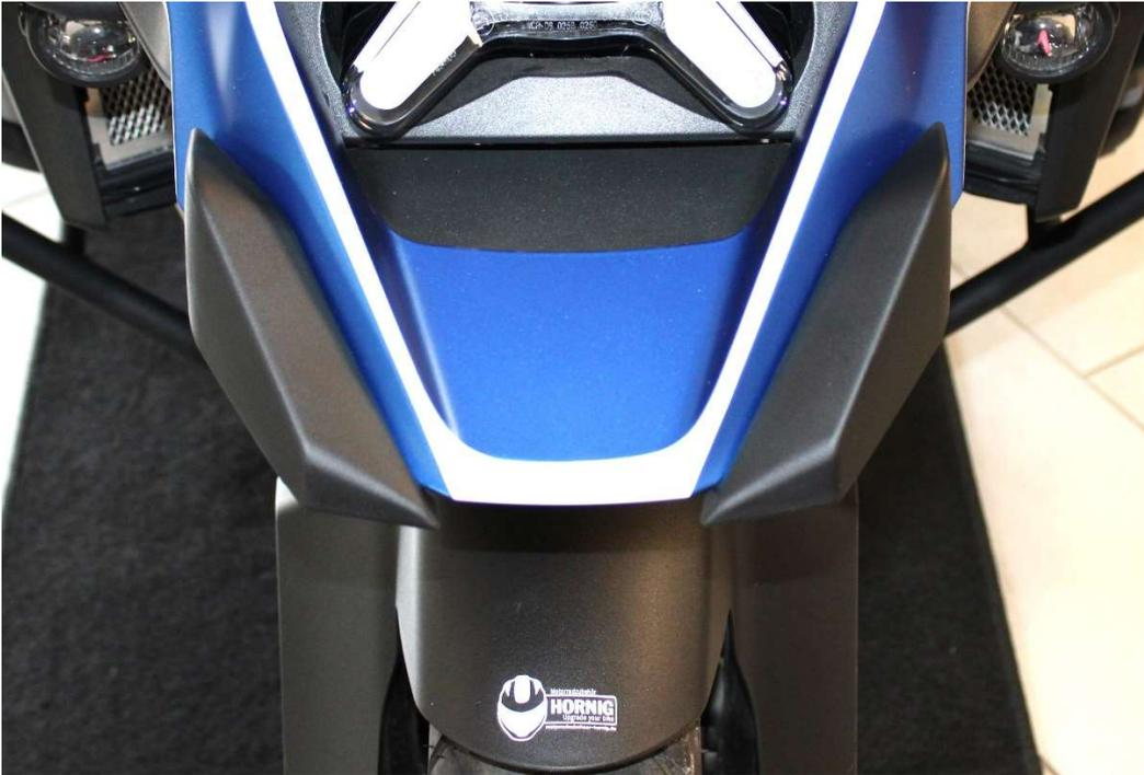
**Schritt 4: Befestigen Sie beide Endkappen mittels der Spreiznieten. Setzen Sie diese ein und drücken Sie den Stift der Spreizniete nach innen, bis er bündig ist und einrastet.**
