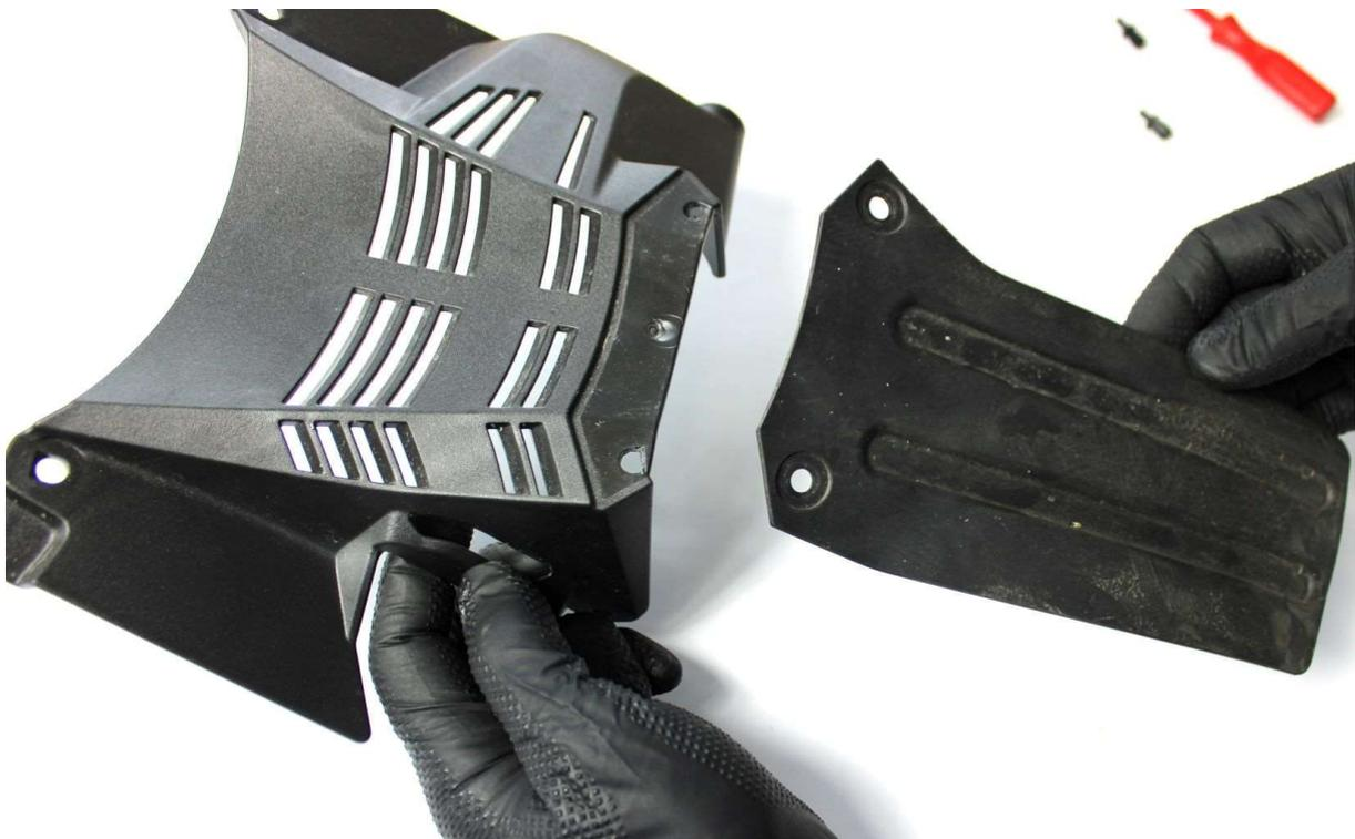
Entfernen Sie den alten Spritzschutz / *Remove the old splash guard*
