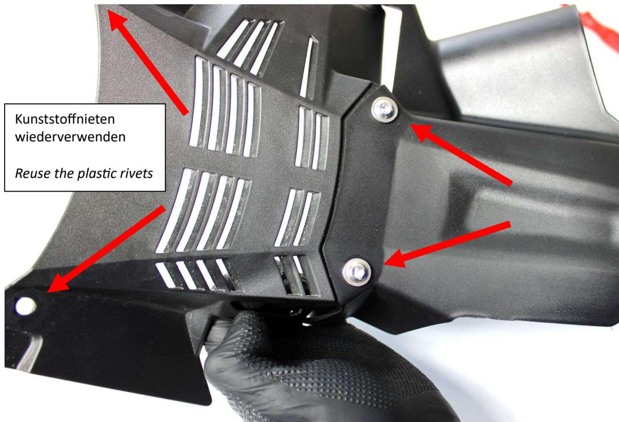
Schrauben Sie den neuen Spritzschutz mit den mitgelieferten Schrauben und Muttern an und bauen Sie den Innenkotflügel wieder ein. Für die Schrauben links und rechts verwenden Sie den mitgelieferten Mutterhalter. Mit etwas Papier können Sie die Mutter im Halter festklemmen.
