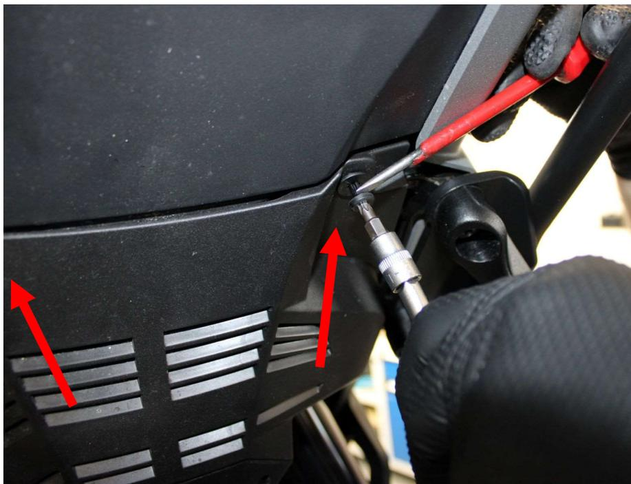
Entfernen Sie beide Kunststoffnieten. Verwenden Sie dazu einen Schraubenzieher zum zurückschieben und drehen gleichzeitig den Torx Kopf
